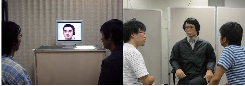
図 6.6: Geminoid HI-1 とビデオ会議システムを使用したオペレータとのアイコンタクトの例
