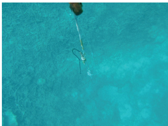
図4 切断した通信ケーブル
