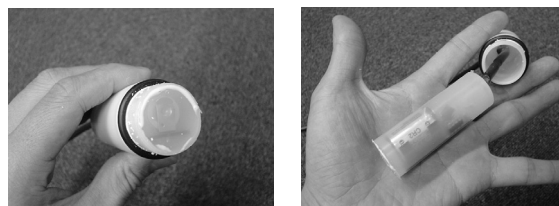
図 5 水温計のシリコンモールド
