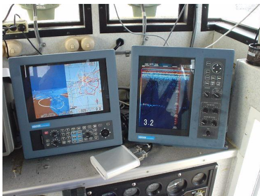
図 1 GPS プロッタ（左）と魚群探知機（右）
