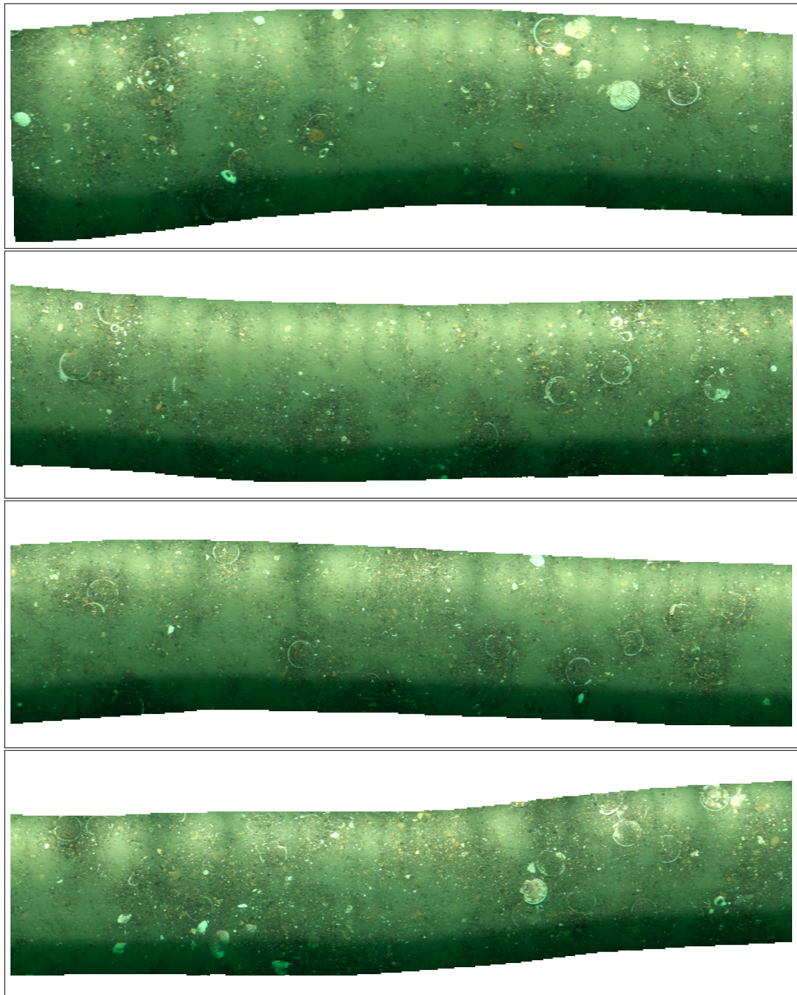
図 5.28: 海底動画を用いたパノラマ画像の例. Sample of panorama seabed image using seabed video.
