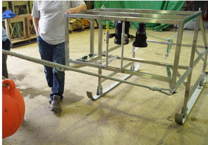
図 3.10: 海底動画の撮影機材. Seabed video apparatus.
