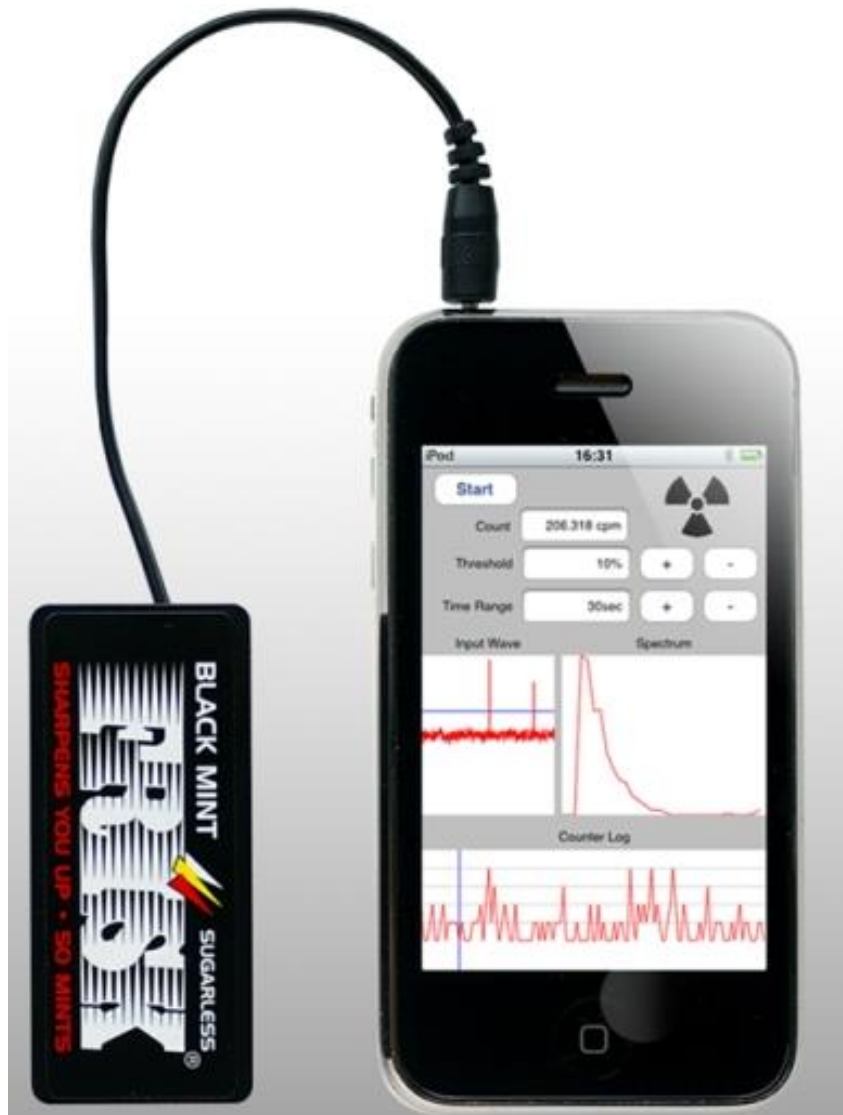
図 2-5 参加型センシングの製品 1 (ヤグチ電子工業の放射線量計)
