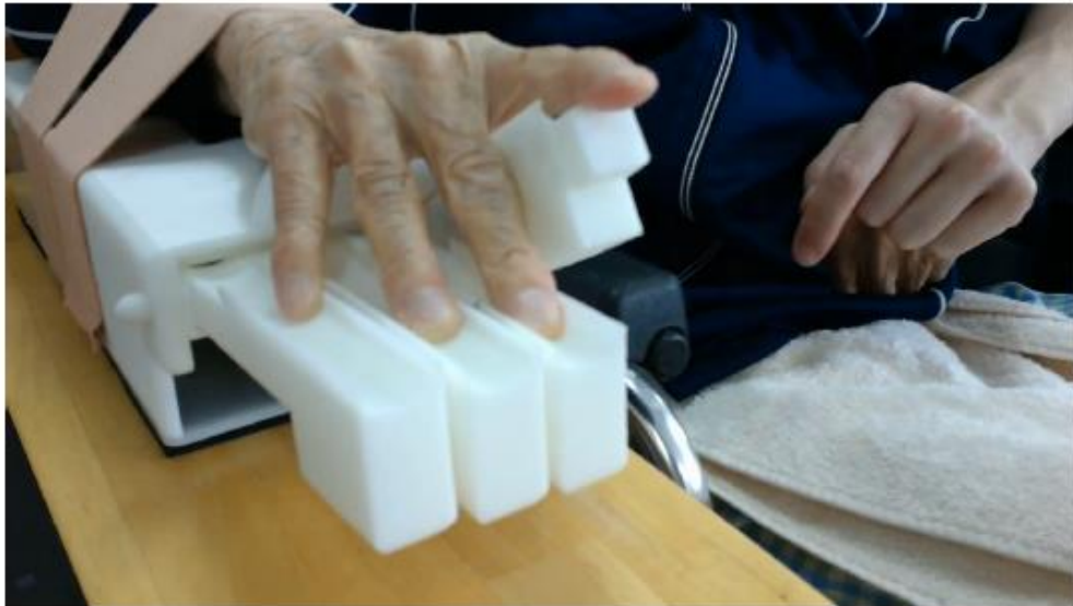
図 31 患者に実装した機器 指上げ中
