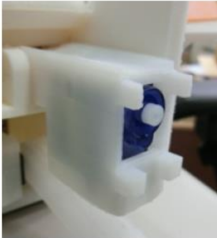
図 34 実際の探索課題アタッチメントのサーボモータ図 2
