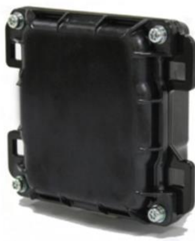
図 1.13：ミリ波レーダー例：富士通テン性ミリ波レーダー
